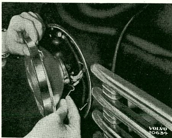
Bild 14. Demontering av lamphållare.
